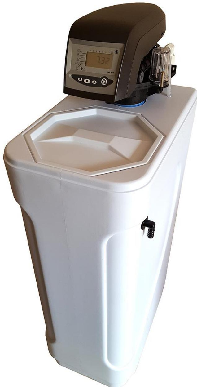
Serija omešivača COMPACT je izvedena tako da je sam omešivač smešten u posudu koja istovremeno služi i kao solanka, odnosno rezervoar tabletirane soli. Ovakva varijanta se odlikuje manjim zauzećem prostora u odnosu na klasičnu varijantu kod koje su omešivač i solanka posebne jedinice.
